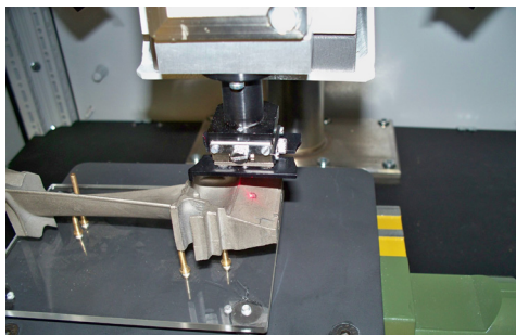
Размещение образца на двухкоординатном столе в рентгенозащитной камере
