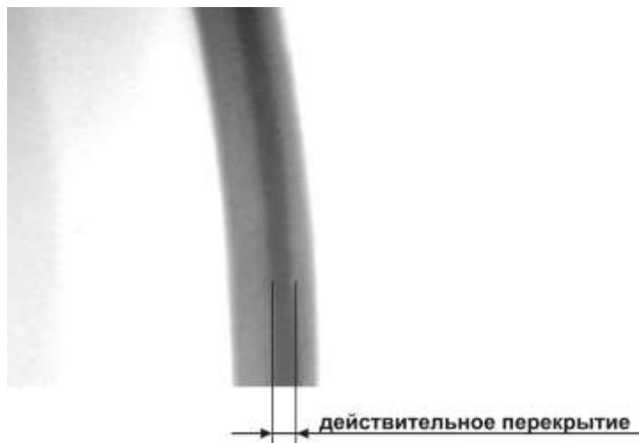
Рис. 3: Рентгеновский снимок фрагмента участка двойного закаточного шва
