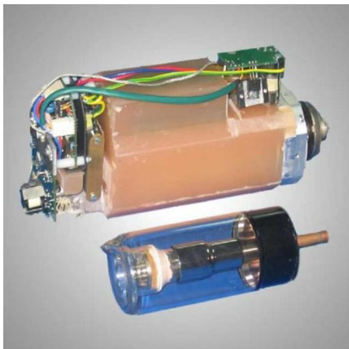
Рис. 2. Моноблок источника рентгеновского излучения и рентгеновская трубка
