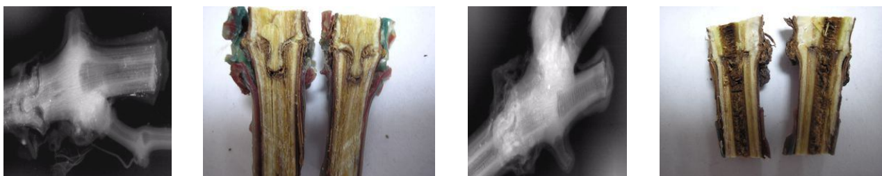
Рис. 3: Рентгенограммы и фотографии разрезов мест спайки саженцев винограда, обладающих сильно выраженными внутренними дефектами
